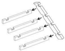
Далее вставить поочередно: 4 рейки-полки, затем 2 рейки-стойки и т.д.
